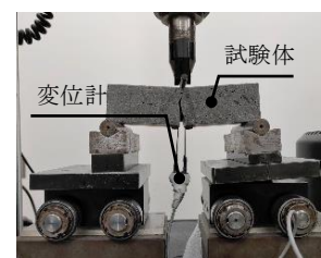
図 3 曲げ試験方法
