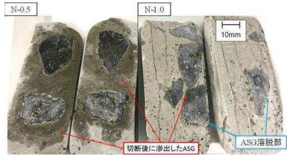
図-2 R 骨材 OCP 埋没後の断面
