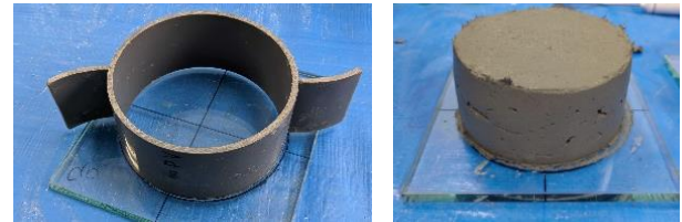
(a) 使用型枠
