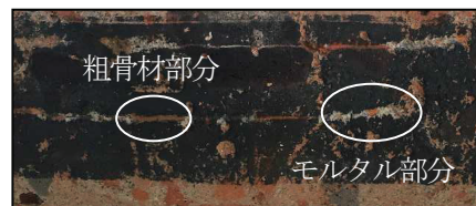
図3 バングラデシュのコンクリートコアの引っかけ傷跡
